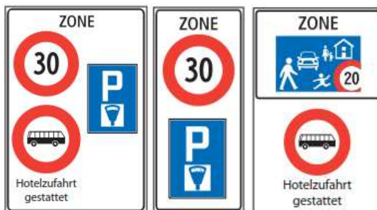
Abbildung 2: Links: Kombiniertes Zonensignal Zone 30 (SSV 2.59.1a), Verbot für Gesellschaftswagen (SSV 2.08) und Parkierung gegen Gebühr (SSV 4.20). Mitte: Zone 30 mit Parkierung gegen Gebühr, in der Reiscars erlaubt sind. Rechts: Kombiniertes Zonensignal Begegnungszone (SSV 2.59.5) mit Verbot für Gesellschaftswagen (SSV 2.08).
